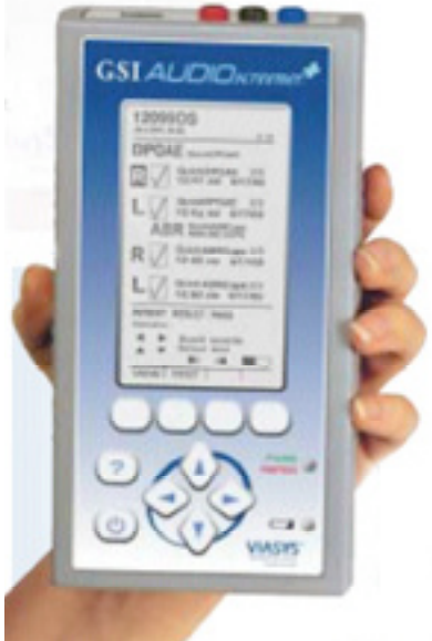
Figura 8: Audioscreener-Plus (AOAE, ABR) dalla Viasys, dispositivo di 4° generazione.
