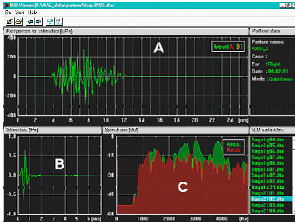
Figura 2: Una risposta TEOAE ottenuta con ILO-292 (Otodynamics) . (A) La risposta si presenta “tagliata” (windowed) tra 4 e 12 ms ; (B) Stimolo acustico; (C) Spettri della risposta (verde) e del rumore (rosso).
