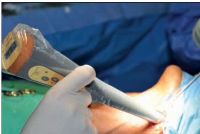
Fig 2: Gamma probe manuale senza fili (Gamma Finder II WOM GmbH Berlin G). Utilizza un'alimentazione a batteria ed in aggiunta al segnale acustico, la radioattività viene evidenziata sul display in cps ogni secondo.
