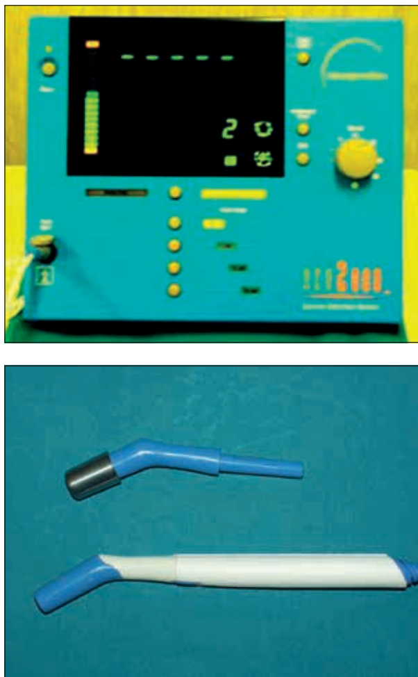
Fig. 1: Gamma probe Neo 2000 (Devicor Medical Products, Inc., Cincinnati, OH). L'unità di controllo riporta nel display la radioattività misurata con intervallo temporale di 20 sec espressa sia in termini numerici, che in scala verticale in funzione del segnale sonoro riprodotto. Sotto viene mostrato il probe con il collimatore rimuovibile.
