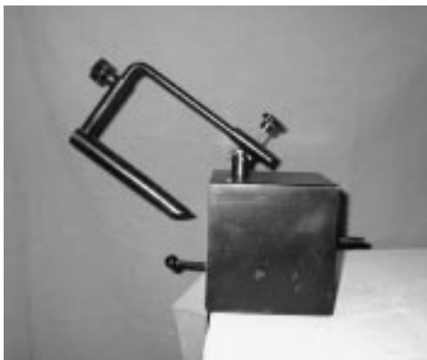
Fig. 8: Laring box 2 con laringoscopio fissato sull'apparato di sospensione.
