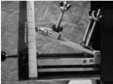
Fig. 7: Escursione massima sull'asse verticale del supporto laringeo
